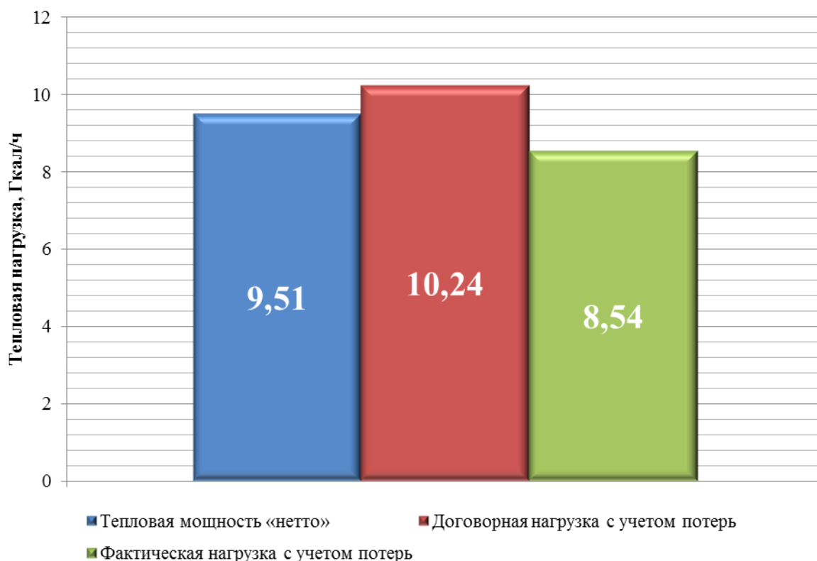
Рисунок 43 – Баланс тепловой энергии в системе теплоснабжения на базе котельной по адресу: ул. Фрунзе, 83а
