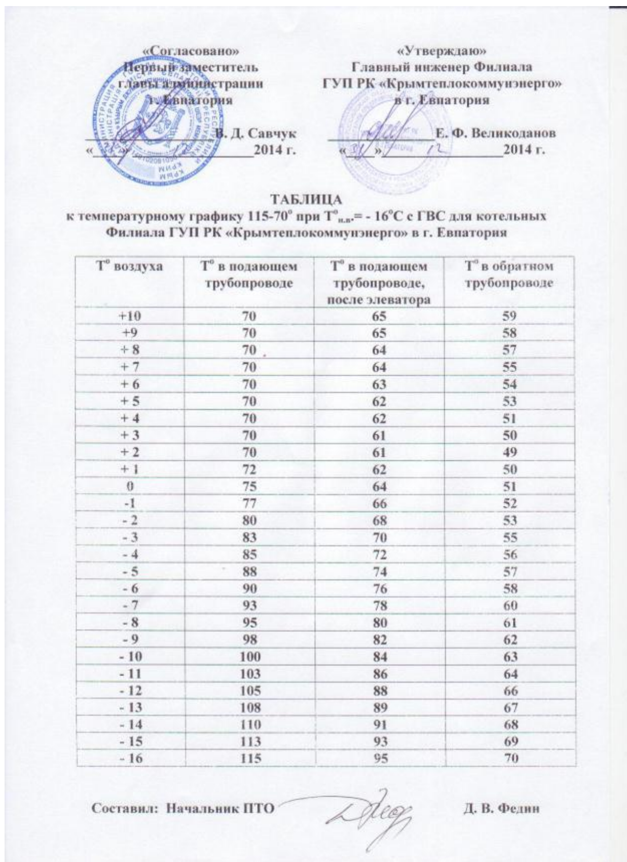
Рисунок 11 – Утвержденный температурный график 115-70°С с наличием нагрузки ГВС
